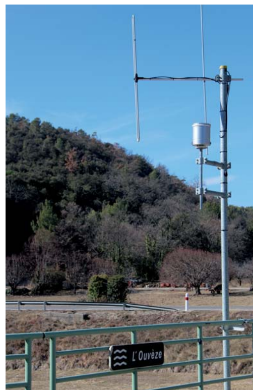
Station hydrométrique sur l'Ouvèze
